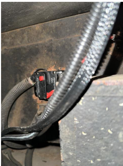
Disjoncteur en position fermée (sauté)
