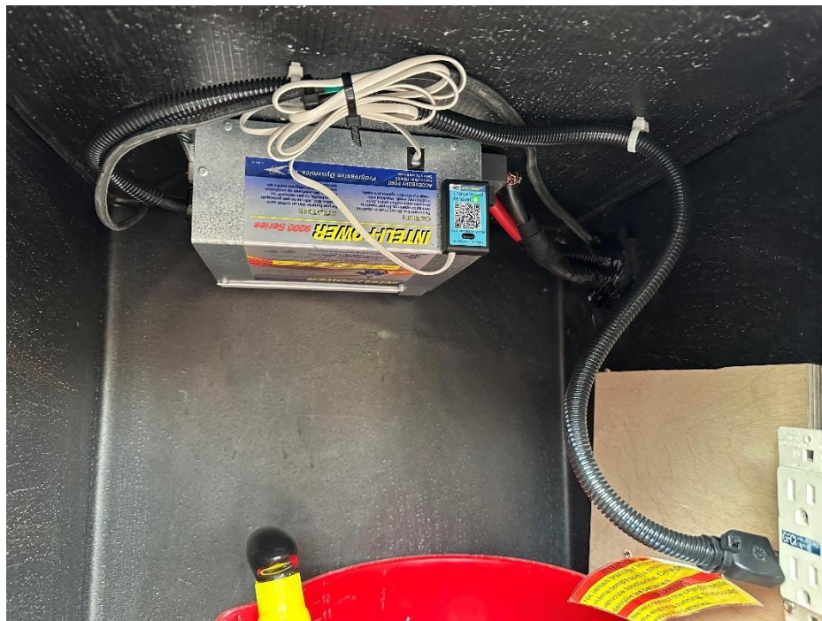
Le chargeur se branche dans la prise de courant.
