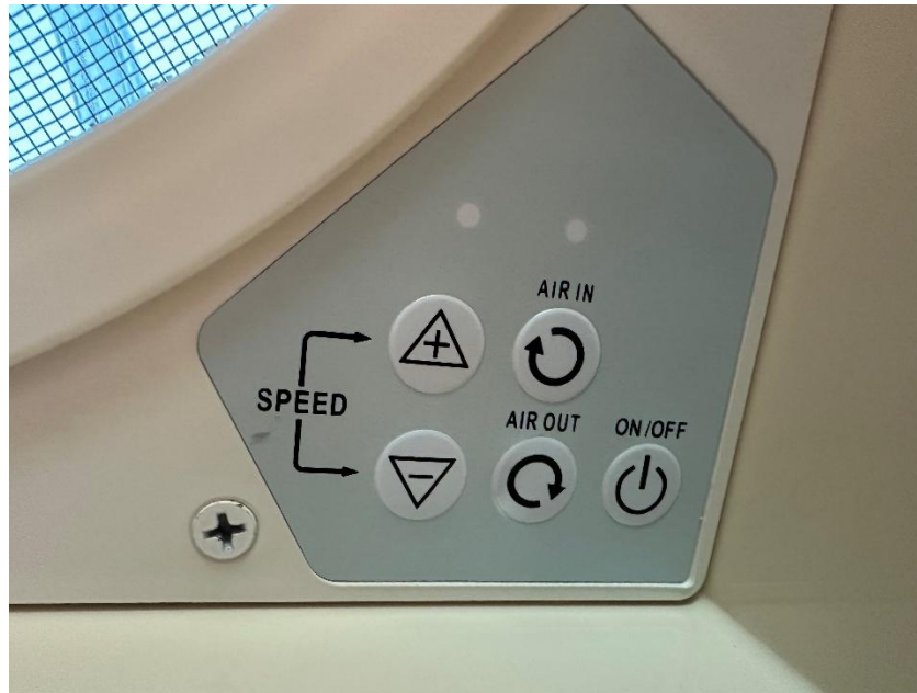
Aperçu des commandes du ventilateur.
