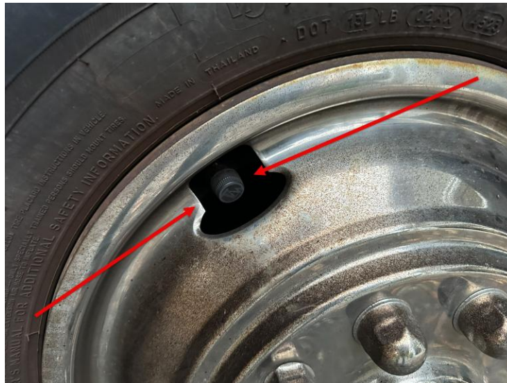
On voit le senseur de pneu avant qui est en retrait
