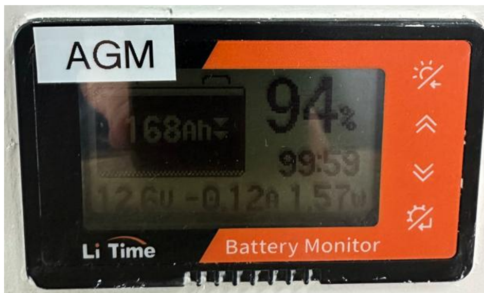
Indication du voltage des batteries AGM
